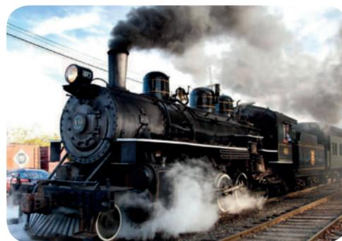
■ En las antiguas locomotoras de vapor, el que se generaba en la combustión ponía en movimiento los pistones, que, a su vez, impulsaban las ruedas mediante un juego de bielas.
