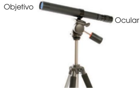
El telescopio permite la visión de objetos muy lejanos cuya luz llega muy débil hasta nosotros. Un telescopio sencillo está formado por un tubo con una lente convergente en cada uno de sus extremos (el objetivo y el ocular).
